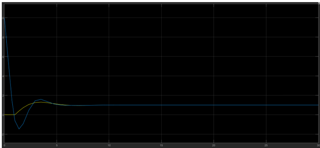
FIGURE 14 – Comparaison de la sortie du système avec celle de l'observateur avec conditions initiales non nulles
